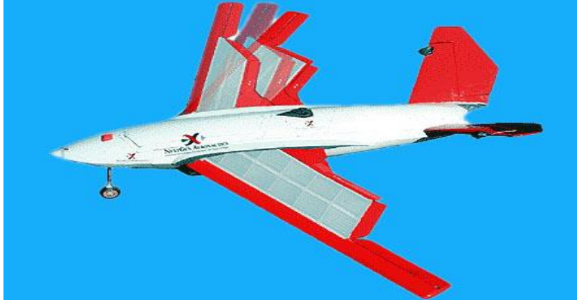
Şekil 20. NextGen Firmasının "Değişken Açız, Değişken Veter" Konsepti
