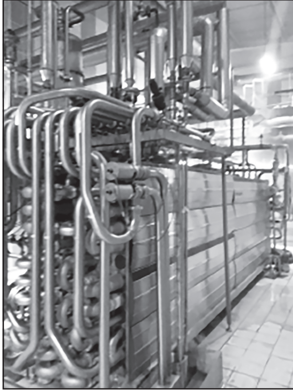
Resim 1: Çok yüksek sıcaklığa erişebilmek amacıyla kullanılan enerji değıştirici.
