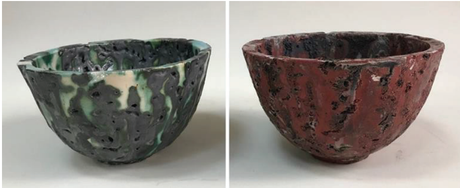
Görsel 16. Bakır Metali Katkılı Çanağın Nötr Fırın Atmosferinde (Solda) ve İndirgen Fırın Atmosferinde Pişmiş Görselleri (Sağda)
