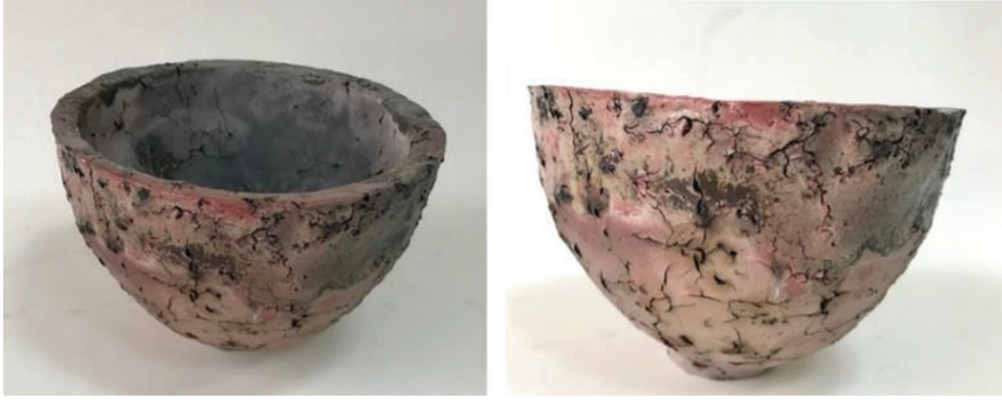
Görsel 17. Çelik Alaşım Katkılı Çanağın İndirgen Fırın Atmosferinde Pişmiş Görselleri
