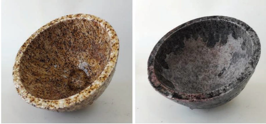
Görsel 18. Demir Talaşı Katkılı Çanağın Nötr Fırın Atmosferinde (Solda) ve İndirgen Fırın Atmosferinde Pişmiş Görselleri (Sağda)
