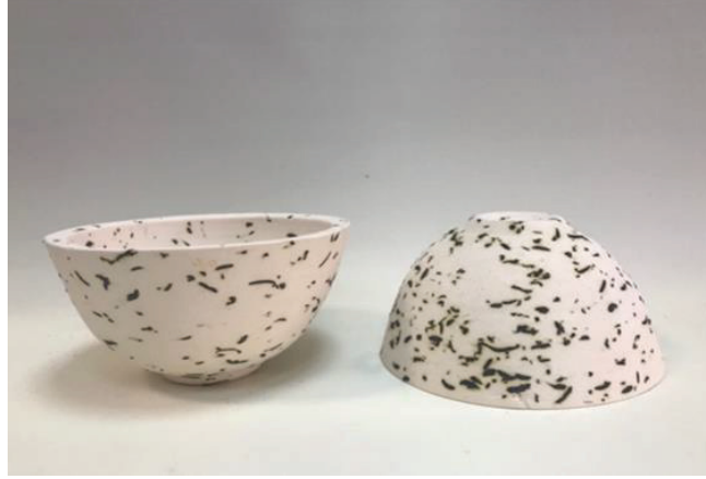
Görsel 14. % 5 Bakır Teli Atığı Katkılı Stoneware Çanak, 1040°C
