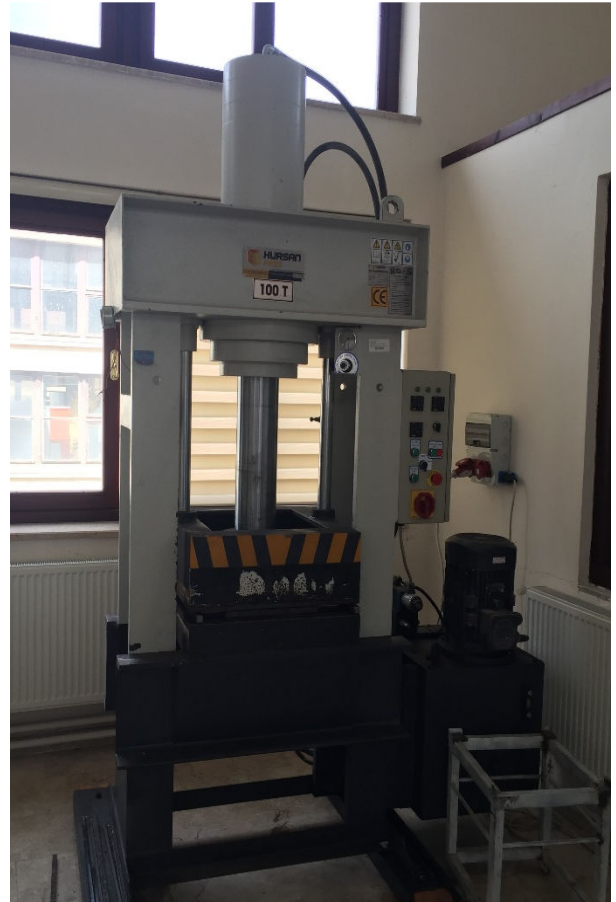
Şekil 2: Sıkıştırılarak yoğunlaştırma işlemlerinde kullanılan hidrolik pres (Gazi Üniversitesi)
