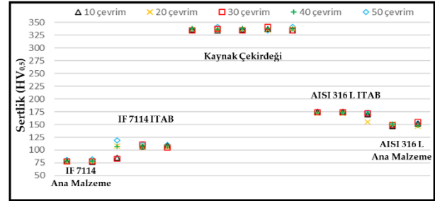
Şekil 8: 3 kN elektrod kuvveti ve 5 kA kaynak akımında birleştirilmiş numunelerin sertlik grafiği.
