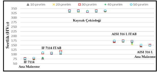
Şekil 7: 3 kN elektrod kuvveti ve 3 kA kaynak akımında birleştirilmiş numunelerin sertlik grafiği.
