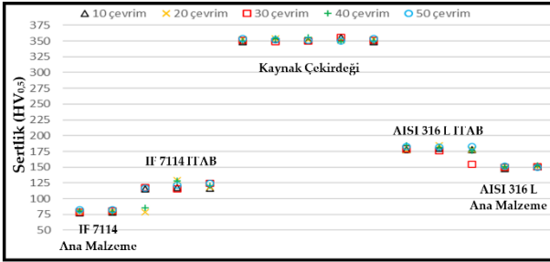
Şekil 12: 6 kN elektrod kuvveti ve 5 kA kaynak akımında birleştirilmiş numunelerin sertlik grafiği.
