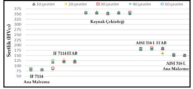
Şekil 14: 6 kN elektrod kuvveti ve 9 kA kaynak akımında birleştirilmiş numunelerin sertlik grafiği.
