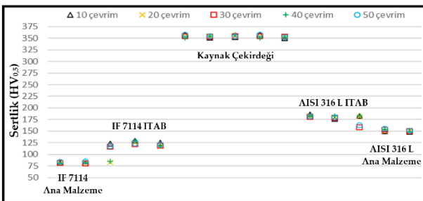
Şekil 13: 6 kN elektrod kuvveti ve 7 kA kaynak akımında birleştirilmiş numunelerin sertlik grafiği.
