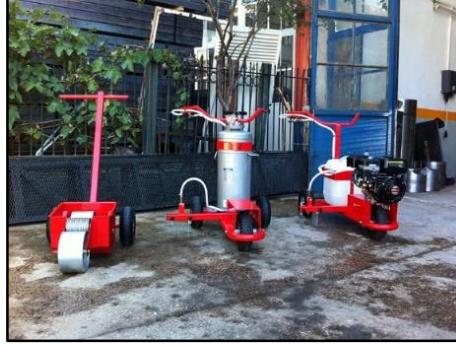
Şekil 13. Çizgi işaretleyiciler (soldan sağa) a) Aktarmalı b) Harici pompalı, hava basınç tanklı püskürtmeli c) Dahili pompalı püskürtmeli (Yazar arşivi)
