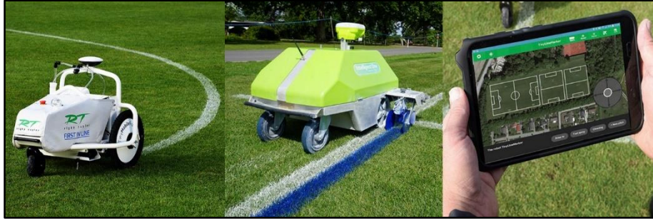
Şekil 19. Püskürtmeli çim işaretleme ekipmanları (soldan sağa) a-b) Püskürtmeli (GPS sistemli otonom) (URL-9; Robson, 2019) c) Kontrol ünitesi (GPS sistemli otonom) (URL-9)
