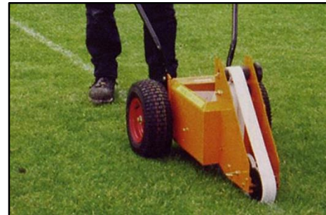
Şekil 14. “Truline” kayış/bant transferli çizgi işaretleyici (URL-4)
