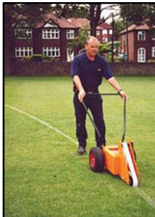
Şekil 14. “Truline” kayış/bant transferli çizgi işaretleyici (URL-4)
