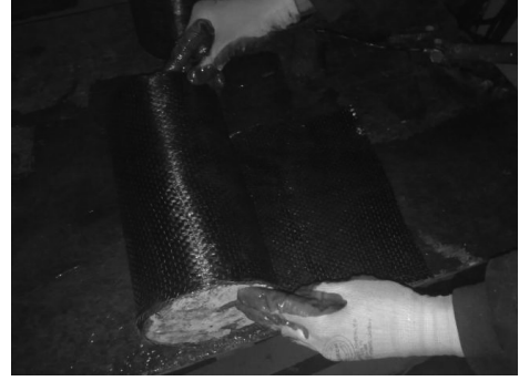
Şekil 5. Karbon Elyafın Numunelere Uygulanması
