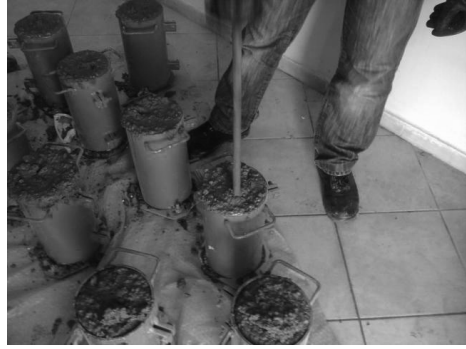
Şekil 3. Kalıp İçindeki Harcın Sıkıştırılması
