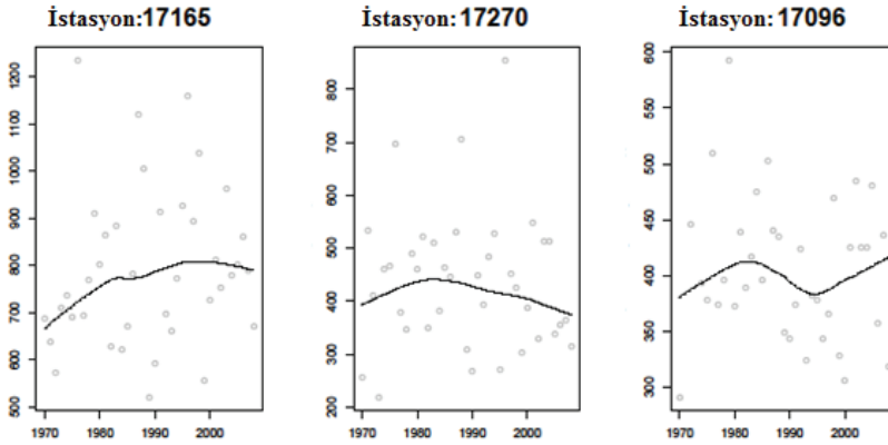
Şekil 6. Üç noktada ölçülen yağış değerleri. Noktalar ölçümleri göstermekte; düz çizgiler modellenen düz çizgilerdir.
