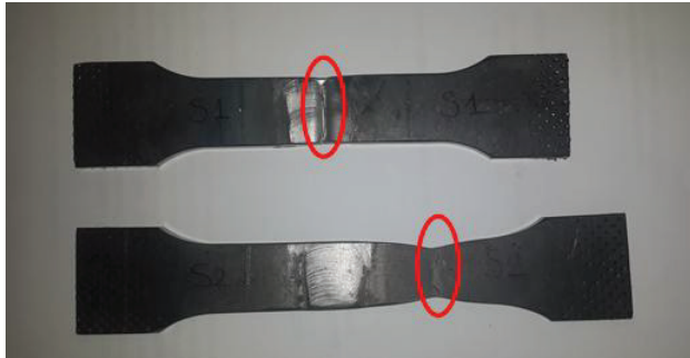
Şekil 3. Çekme Deneyi sonucu numunelerin görüntüsü
