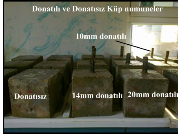
Şekil 1: Farklı donatı çaplı su kürüne maruz bırakılmış betonlar Figure 1: Concretes exposed to water cure with different reinforcement diameters
