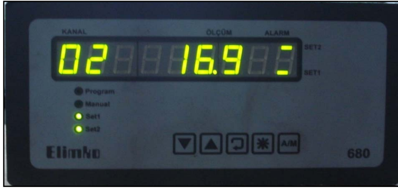
Şekil 4.7. Elimko E – 680 serisi universal girişli gelişmiş tarayıcı
