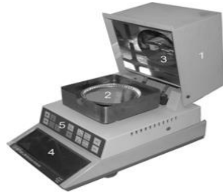
Şekil 1. Mettler LJ16 infrared kurutucu. (1) IR radyatör, (2) Alüminyum numune kabı, (3) Sıcaklık sensörü, (4) Ekran, (5) Kontrol paneli
