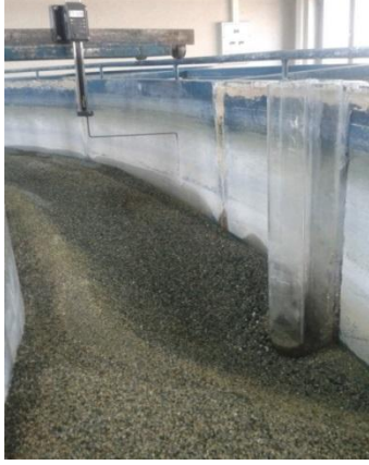
Şekil 10. Köprü kenar ayağında oluşan oyulma ( L_a=10 cm)
