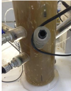
Şekil 6: PVA boncuklarının MBR'deki görünümü.
