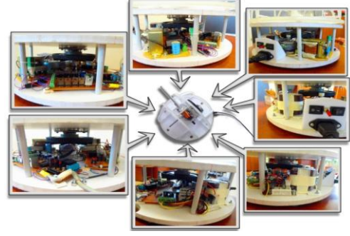
Şekil 3: Tasarlanan elektronik devreler ve dönme hareketini sağlayan düzenekler
