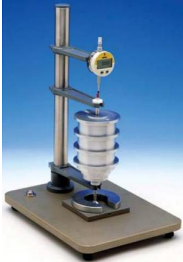
Şekil 2. WIRA Dijital kalınlık ölçer [15].
