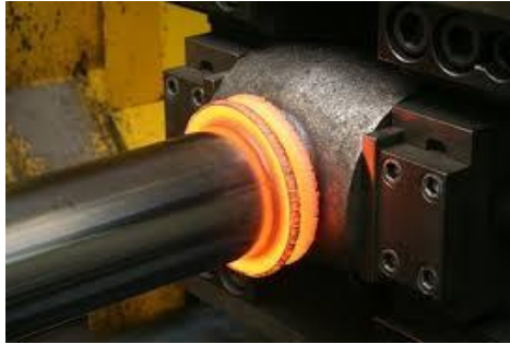
Figure 4. The yoke shaft during CDFW operation (CDFW işlemi sırasında çatallı mil)
