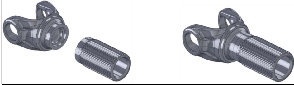
Figure 3. 3D data of tube yokes, hollow round bar and welded yoke shaft (Çatal, içi boş yuvarlak çubuk ve kaynaklı çatallı milin 3B verileri)
