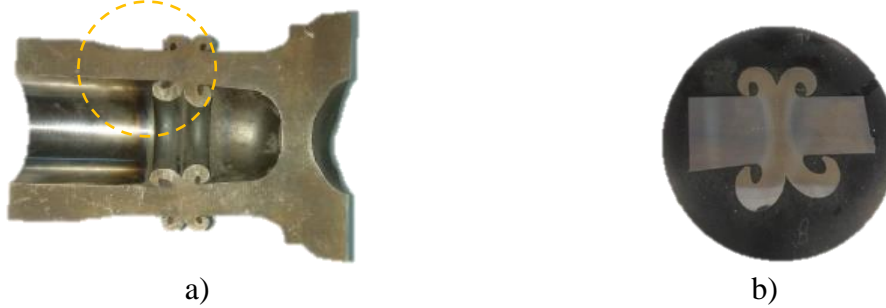
Figure 8. A specimen under macroscopic inspections, a) welded yoke shaft, b) specimen sectioned from welded yoke shaft (Makroskopik incelemeler altındaki bir numune, a) kaynaklı çatallı mil, b) kaynaklı çatallı milden kesit numune).
