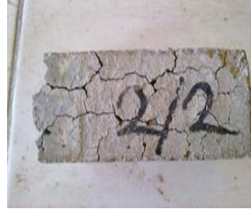
Şekil 8. Sülfatta ıslanma-kuruma çevrimi sonrası genişleyen numune
