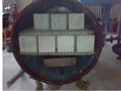
Şekil 4. Gaz sızdırmaz tanka yerleştirilen beton numuneleri
