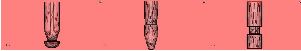
Şekil 3. Frez tipleri ve mesh yapısı
