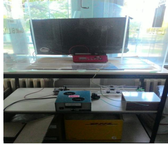
Şekil 2.1. Elektrostatik nanolif çekim düzeneği
