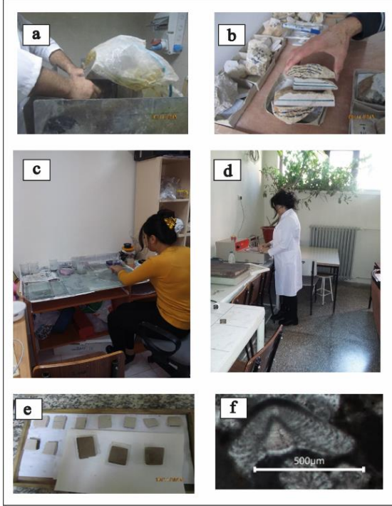
Şekil 4. a ve b) Örneklerin plakalar halinde kesilmesi, c) Aşındırma tozlarıyla aşındırma, d) Döner diskte parlatma, e) Buğulu hale getirilmiş lama yapıştırma, f) İnce kesit görüntüsü ( Halkyardia minima ).
