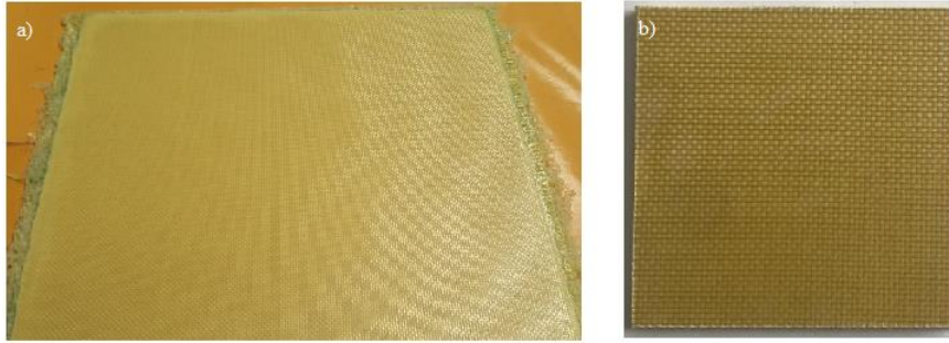
Şekil 1. Kevlar plaka üretimi a) kumaş ve reçine uygulaması b) sıcak presleme sonrası kesilerek hazırlanan kevlar zırh katmanı.
