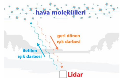
Şekil 2. Doppler rüzgâr LIDAR'ı çalışma prensibi
