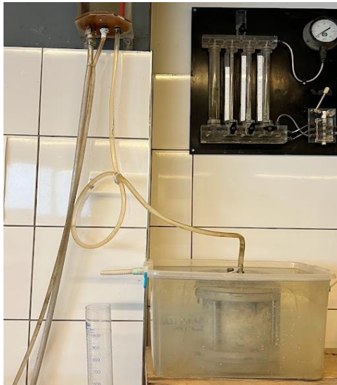
Şekil 5. Permeabilite deney düzeneği ve permeabilite katsayıları grafiği
