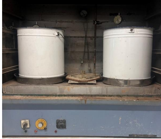
Şekil 8. Hızlandırılmış şişme testi kurulumu
