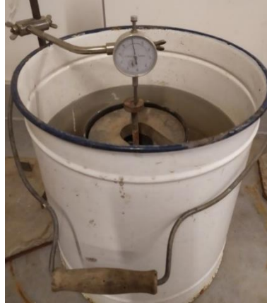
Şekil 7. Numuneyi suya doyurma işlemi
