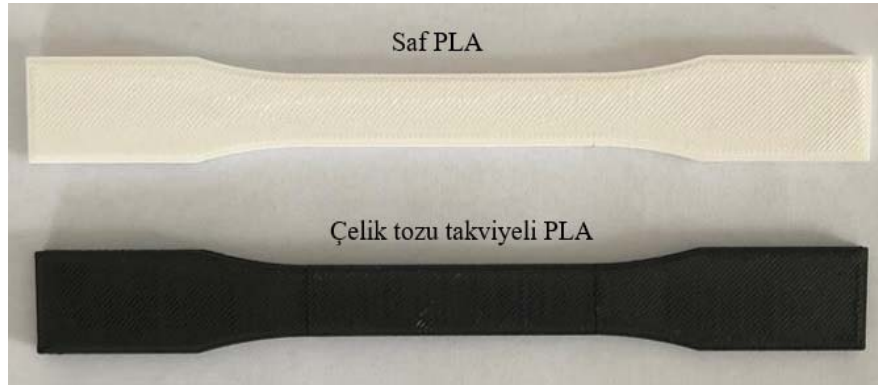
Şekil 5. Çekme deney numuneleri (Tensile test specimens)
