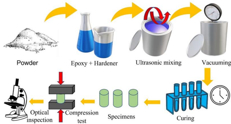
Figure A: Schematic representation of production and testing phases. / Şekil A: Üretim ve test aşamalarının şematik gösterimi.
