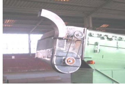
Şekil 3. Prototip hasat-harman makinasının sap kıyıcı ve pnömatik iletim düzeni
