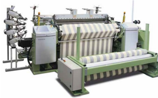
Şekil 1. Hava jetli dokuma tezgâhı [1].
