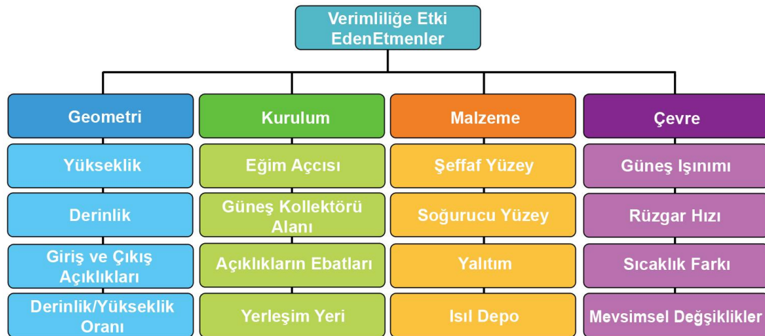
Şekil 4. Güneş bacasının verimliliğine etki eden etmenler
