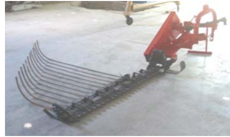
Şekil 1. Çift bıçaklı çayır biçme makinasının ve ilave edilen namlu düzeninin genel görünüşü
