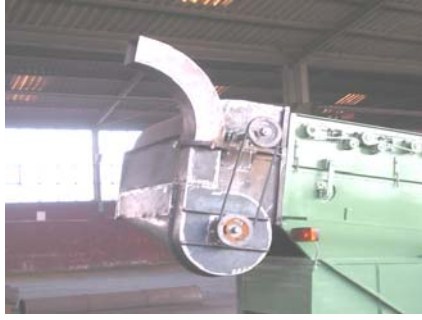
Şekil 3. Prototip hasat-harman makinasının sap kıyıyıcı ve pnömatik iletim düzeni
