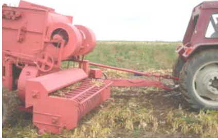
Şekil 10. Prototip hasat-harman makinası ile fasulye hasadı
