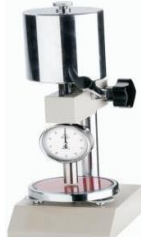
Şekil 11. Sertlik ölçüm cihazı (Figure 11. Hardness tester)
