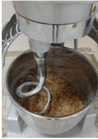
Şekil 3. Kil ve bazalt fiber karışımlarının hazırlanması Figure 3. Preparation of clay and basalt fiber mixtures
