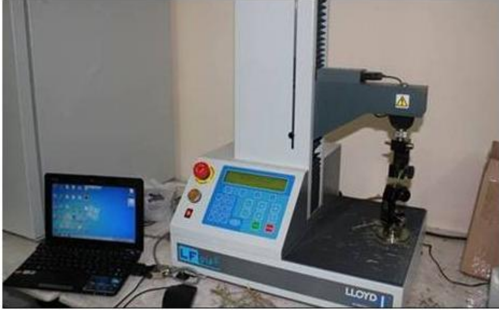
Şekil 1. Biyolojik test cihazı ile yaprakların kopma kuvvetinin belirlenmesi Figure 1. Determination of leaf of Salvia officinalis by universal testing machine
