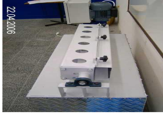
Şekil 4. SPLP proseslerinde kullanılan döner çalkalama aygıtı (Liç Reaktörü), (Yıldız, 2008)
