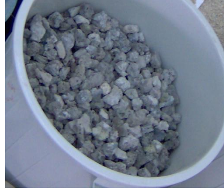
Şekil 2. FeCr cürufları 25 mm'den büyük (solda) ve 20-25 mm arası boyutlu (sağda)
