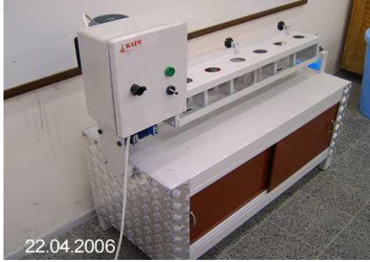
Şekil 4. SPLP proseslerinde kullanılan döner çalkalama aygıtı (Liç Reaktörü), (Yıldız, 2008)
