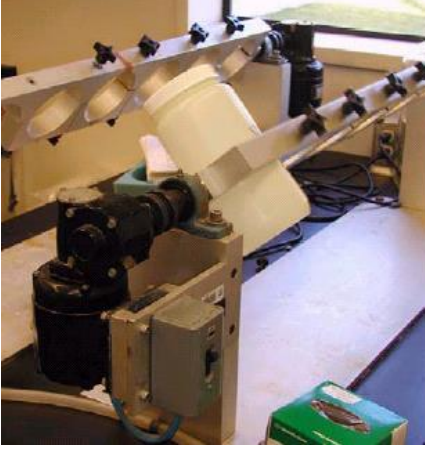
Şekil 3. TCLP ve SPLP proseslerinde numune ekstraksiyonunda kullanılan döner çalkalama aygıtı (Pendowski, 2003)
