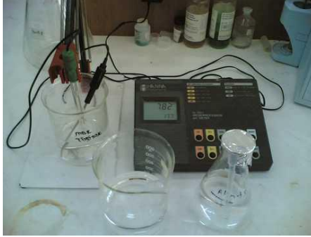
Şekil 6. Liç ekstraksiyon numunesi ve pH metre ile son pH ölçümü
