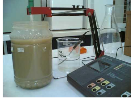
Şekil 6. Liç ekstraksiyon numunesi ve pH metre ile son pH ölçümü
