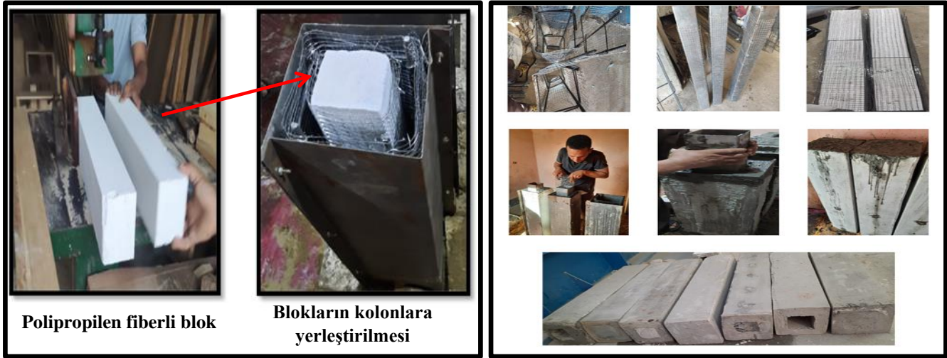
Şekil 4. Polipropilen fiberler ve ferrocement ile üretilen betonların üretim aşamaları (Eltaly vd., 2023)
