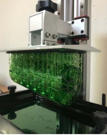
Şekil 5. Üretimi gerçekleştirilen bio-ilhamlı profil (Bio-inspired profile produced)
