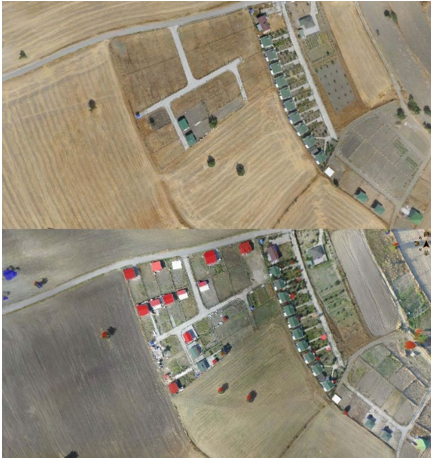
Şekil 4. İkinci bölümde alanı manuel olarak taramak sureti ile yazılımın boyadığı alanlar işaretlenip point verisi olarak export edilmiştir. Akabinde işaretli bölgelerde yapı ruhsatı ya da ruhsat başvurusu olup olmadığı araştırılmıştır.
