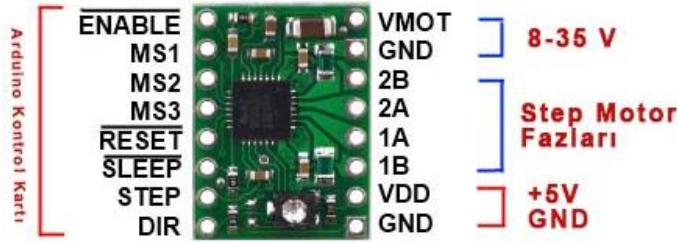
Şekil 6. A4988 sürücü kartı bağlantı şeması
