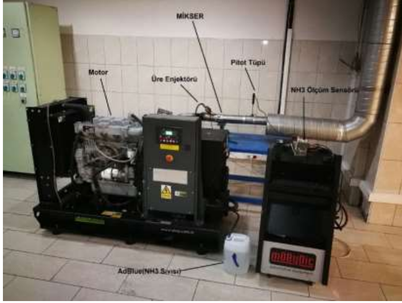
Şekil 9. UI NH 3 ölçüm test düzeneği resmi.
