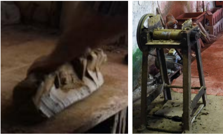
Fotoğraf 7: Salih Karayiğit'in yoğurduğu çömlek çamuru ve çamur içindeki taşları ve toprakları parçalamak için kullanılan çamur ezme makinası.
