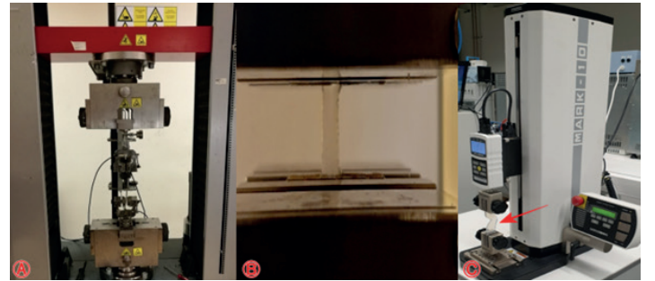
Şekil 5. Laboratuvar testleri ile dokuların mekanik özelliklerinin gerçeklik testi. A ve B: Universal test makinası ile çekme testi deney düzeneği. C: Yırtılma mukavemeti ölçümünde kullanılan Mark-10 marka masa üstü Universal test makinası ile çekme deney düzeneği.
