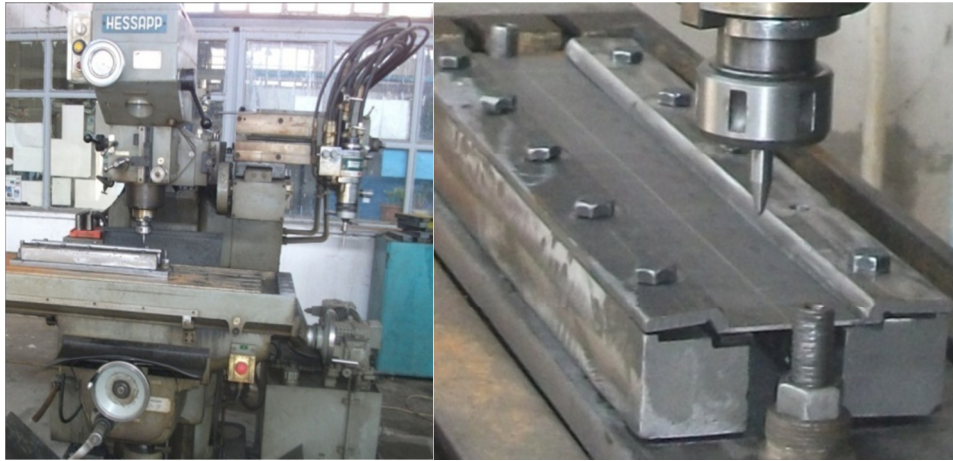
Şekil 1. Deney düzeneği ve deneysel çalışmada kullanılan bağlama aparatı.
