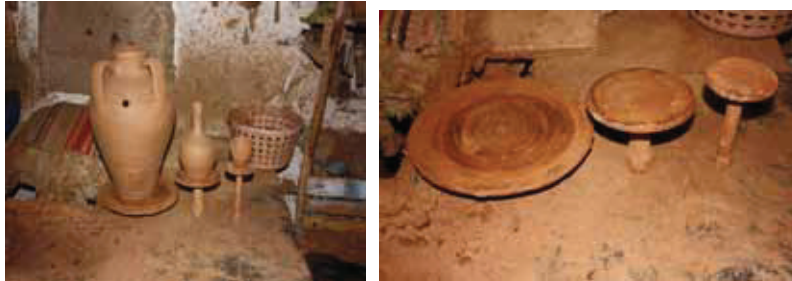
Resim 10. Yapılacak ürüne göre kullanılan tezgâh başlıkları
