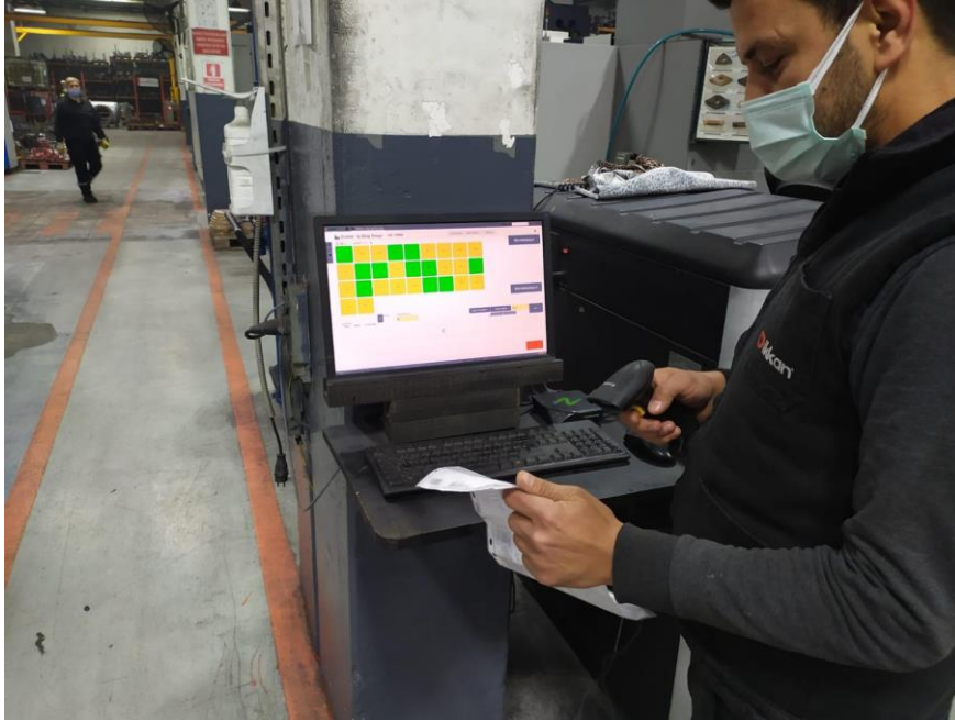
Şekil 13. Barkod Okuma Sisteminin Saha Uygulamasına Ait Görsel (Visual of the Field Application of the Barcode Reading System)
