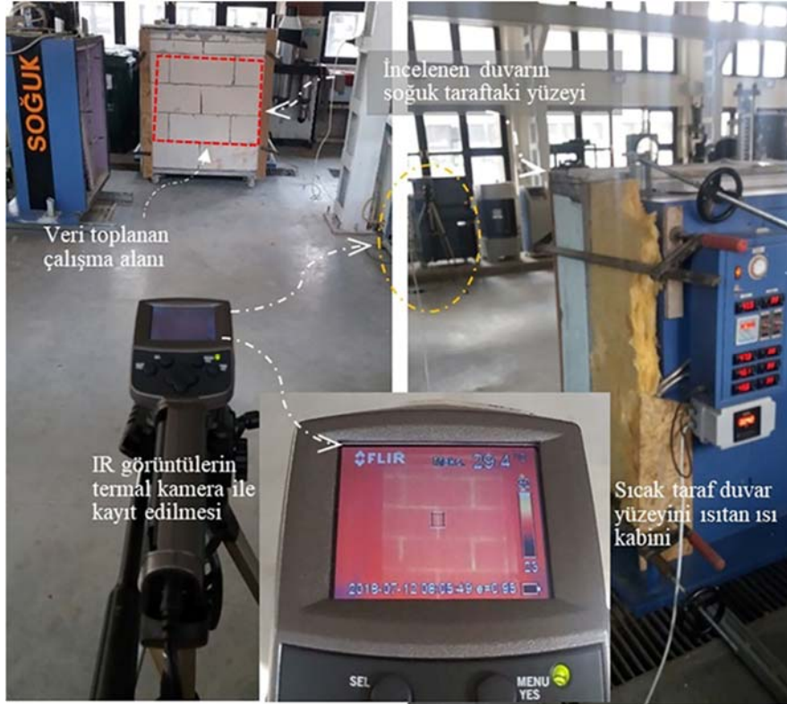
Şekil 4. IRT-GHB deney düzeneğinin laboratuvar ortamındaki farklı açılardan görüntüsünü gösteren fotoğrafları (Photographs showing images of the IRT-GHB experimental setup from different perspectives in the laboratory environment)
