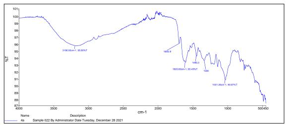
Figure 5. FTIR analysis of CS extract Sekil 5. CS ekstraktının FTIR analizi
