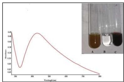
Figure 1. UV-Vis spectra of AgNP using CS extract; Inset figure: A: CS extract, B: AgNO<sub>3</sub> solution, CS – AgNPs Şekil 1. CS ekstraktı kullanılarak AgNP'nin UV-Vis spektrumları; Ek şekil: A: CS ekstraktı, B: AgNO<sub>3</sub> çözeltisi, CS – AgNP'ler
