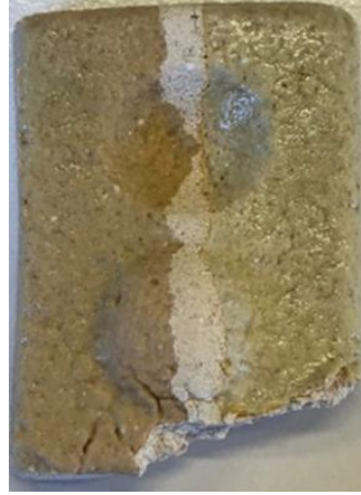
Görsel 1. Saf Gri Kil, Gri kil kuru küçülme % :6, Toplam küçülme %:8.
