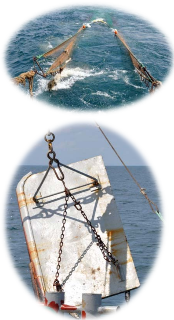
Şekil 2. Dip trol ağının kanatları (kurşun yaka, mantar yaka ve maçalar) ve kullanılan kapı modeli (Kaykaç vd., 2014).
