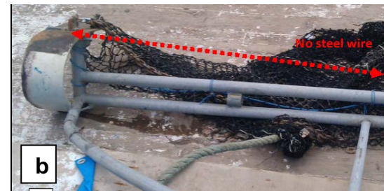
Şekil 10. Geleneksel algarna ağı üzerinde gerçekleştirilen modifikasyonlar: (a) kızak formuna çevrilmiş ayaklar (b) çelik telsiz ağız (Zengin vd, 2014b).
