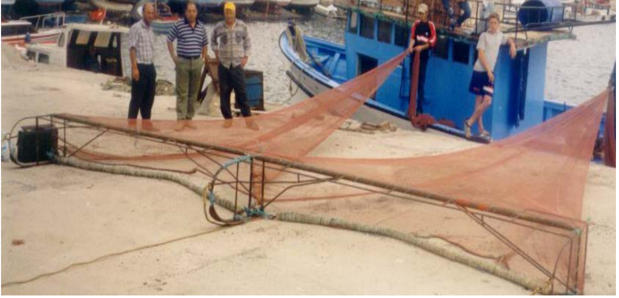
Şekil 12. Marmara denizinde derin su pembe karidesi avcılığında yaygın olarak kullanılan algarna, Barbaros (Tekirdağ) balıkçı barınağı (Zengin vd., 2004).
