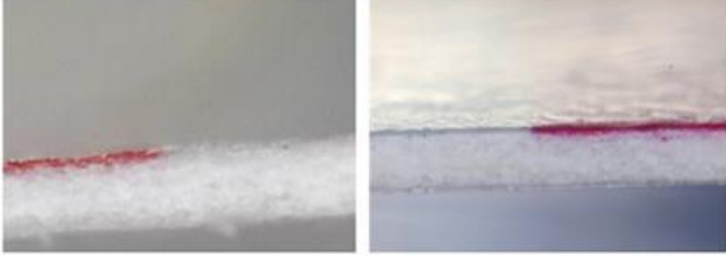
Şekil 3. Kaplanmamış ve kaplanmış zemin baskılı kâğıtta enine kesit mikroskopik görüntüsü.
